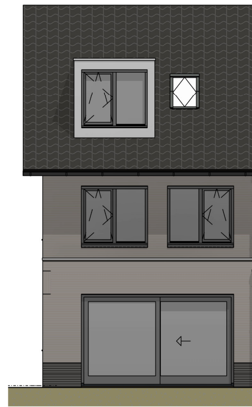
achtergevel met optie schuifpui 1 : 100
