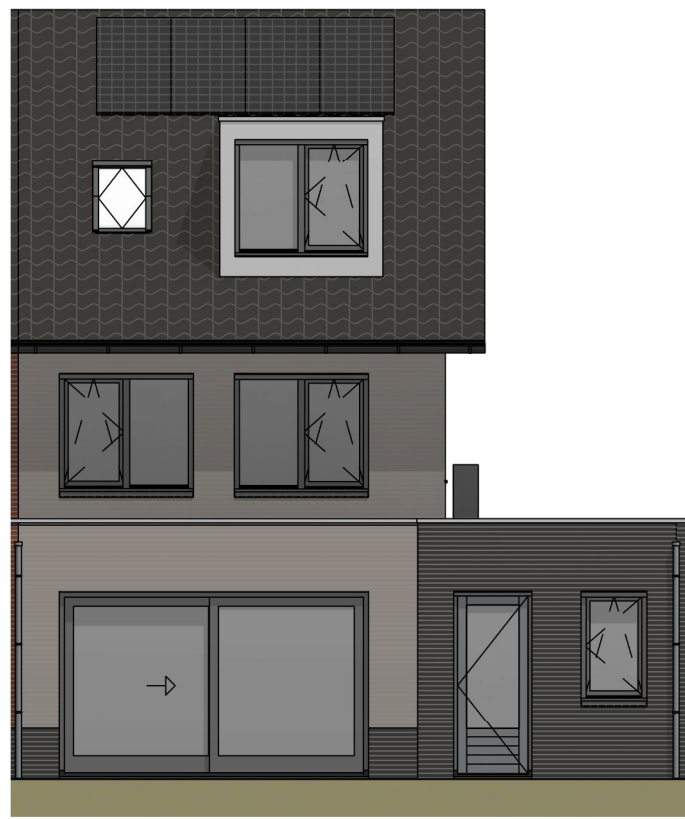
achtergevel met optie schuifpui 1 : 100
