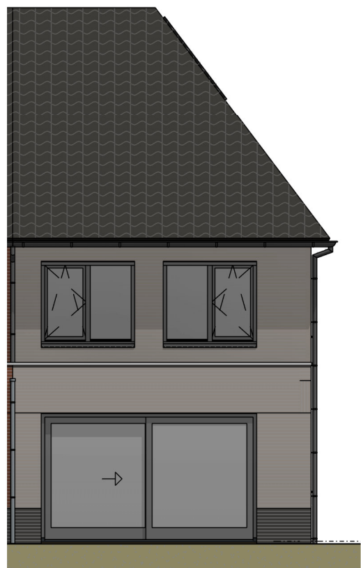
achtergevel met optie schuifpui 1 : 100
